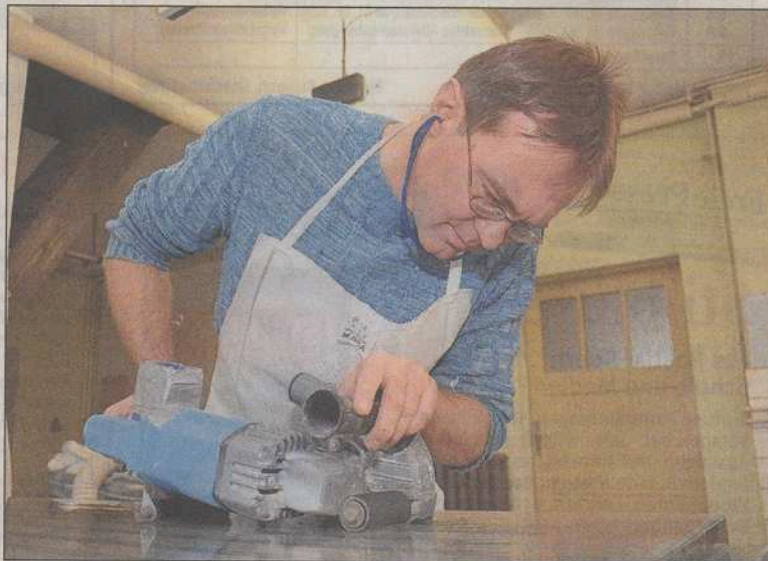
André Winterling von der Firma tibutherm fräst Vertiefungen für die Heizung in eine Steinplatte. Der Steinheizkörper kann an den üblichen Warmwasserheizkreislauf angeschlossen werden.
